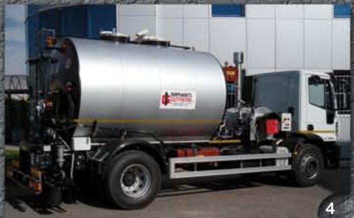
Spruzzatrice idraulica per emulsione , omologata, TIPO SPEM/MP con motore posteriore e caldaia ad olio diatermico.
