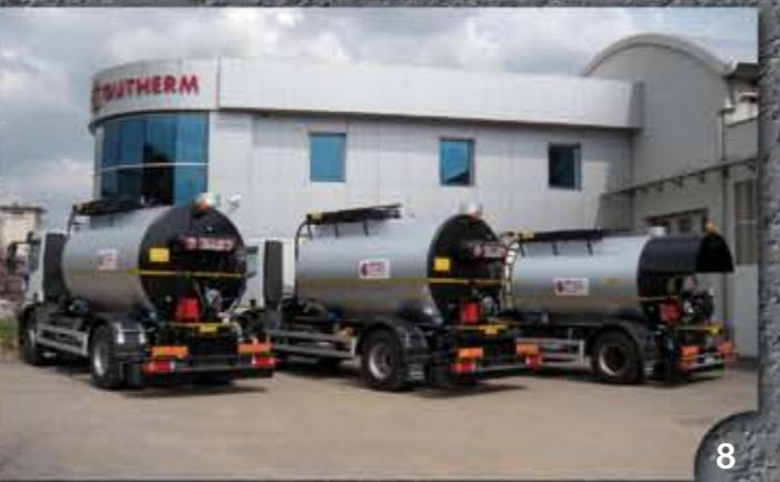
Spruzzatrice per emulsione capacità da 4.000 a 15.000 litri a due scomparti tipo SPE/MP OMOLOGATA
